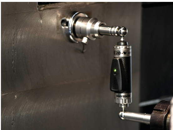
Spirax社のマシニングセンターに使用される QC20-W ワイヤレスボールバー
