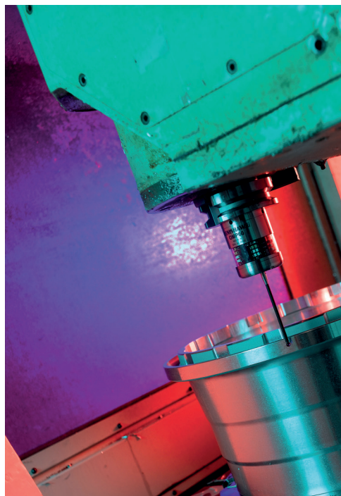
主軸装着式タッチプローブは、既存の形状を基準に機械座標系を設定して、毎回必ず正位置から切削を開始
