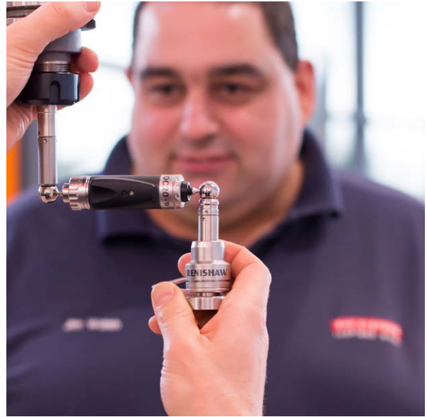
BAE Systems 社の従業員 Jim Walsh 氏とレニショー QC20-W ボールバー
