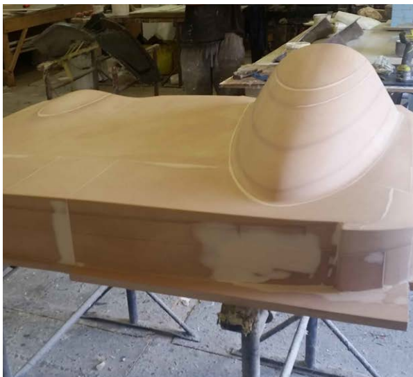
各部品が、グラスファイバーの金型が最低限の手仕上げですむよう、お互いに正確にはまり合うように作製する必要がありました。
