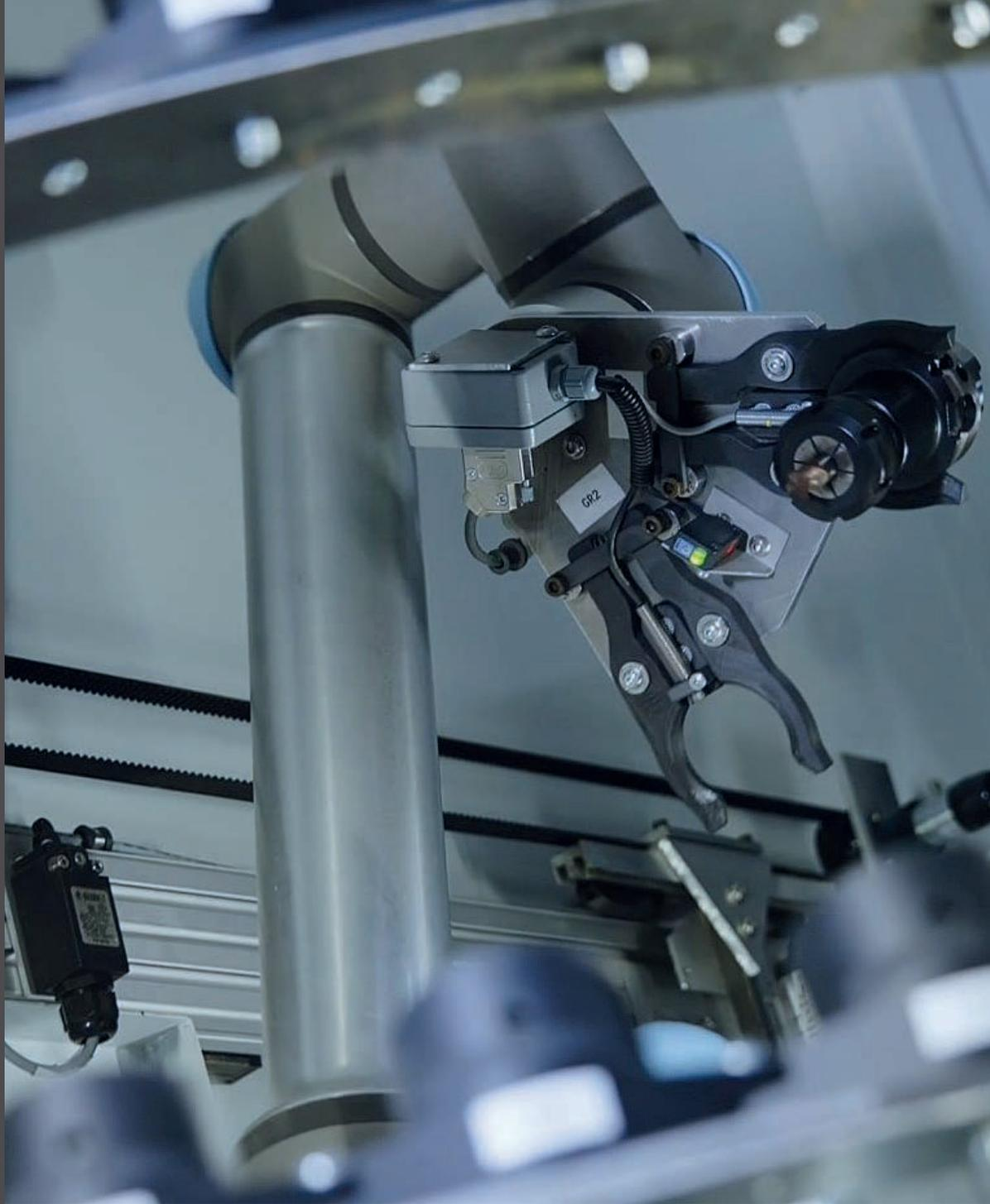
Effective CNC 社がとった画期的な手法は、機械の構造と工具に留まらず、斬新な工具交換ロボットにもおよんでいる。「複雑な工具交換構造を持つ直交座標ロボットを作るのではなく、既存の協働ロボットを選定しました」と Pearson 氏は続ける。
