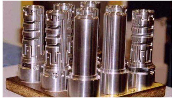
加工済みスピンドル。厳格な公差と高品質な表面仕上げ
