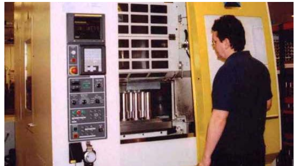
段取り用にプロープを搭載したマシニングセンターが現在、複数ワークのロット生産を実施
