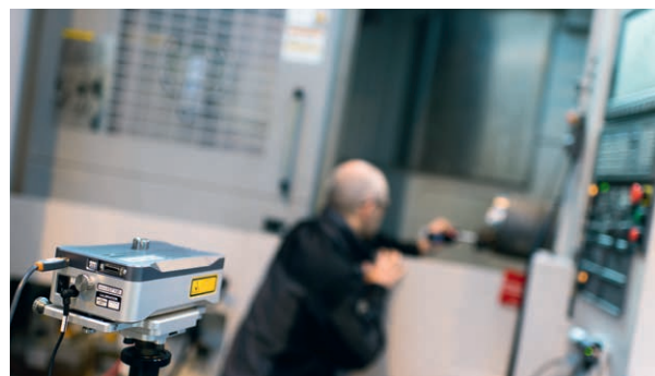
XL-80 レーザーキャリブレーションシステムを使用して機械精度をチェックする FMC Technologies メンテナンス技術者のクレイグ・シン普森氏
