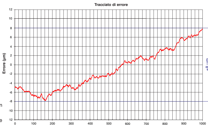
Esempio di risultato del test di accuratezza di una riga RTLA50 di 1000 mm di lunghezza
