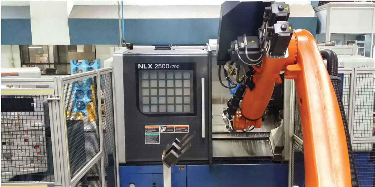
Una cella di lavoro è formata da due torni, un marker, un rilevatore di pezzi, un robot e un calibro Equator.
