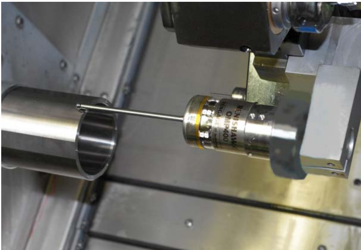
La sonda OMP400 utilizza una speciale misurazione di routine per la circolarità e le cilindricità delle superfici interne ed esterne delle masse di prova.
