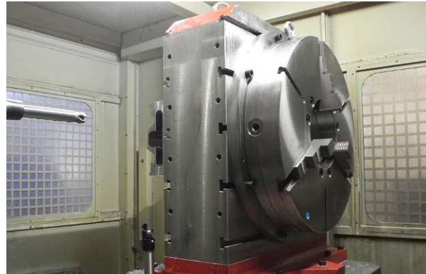
Braccio motorizzato ad alta precisione montato sul centro di tornitura Trevisan.
