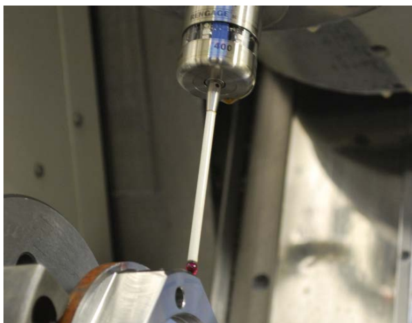
La macchina di tornitura/fresatura multiasse Mazak Integrex con la OMP400 Renishaw nel mandrino
