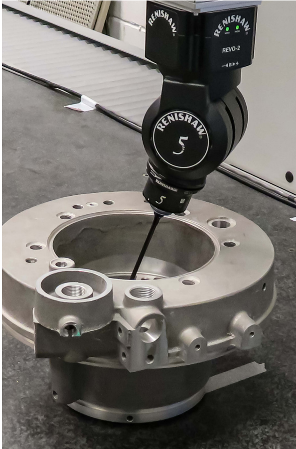
Testa a 5 assi REVO con capacità di posizionamento continuo
