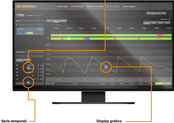
Copre generalmente i dati ambientali come temperatura e pressione, ma può visualizzare qualsiasi dato temporale richiesto (ad esempio, l'override di velocità o la lunghezza dell'utensile).
