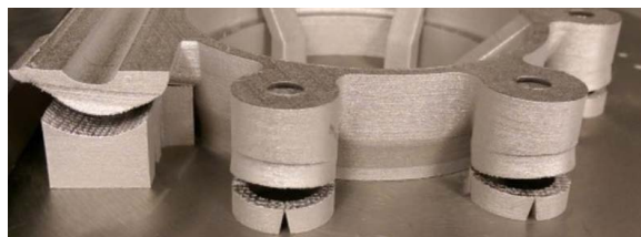
I componenti ottimizzati dal punto di vista funzionale ma non progettati per l'AM possono richiedere molti supporti e rendere così la produzione poco efficiente.
