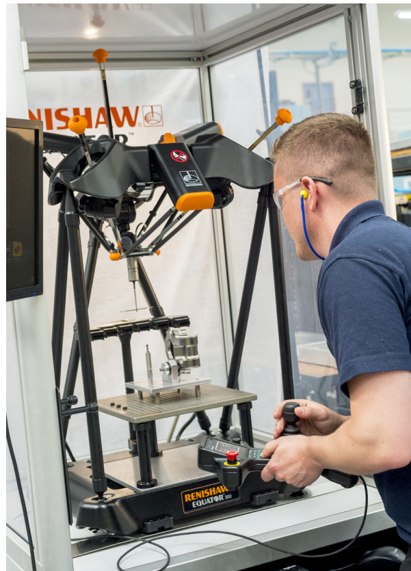
Az Equator rendszer használata a programozott repülőgép-alkatrész méréshez
