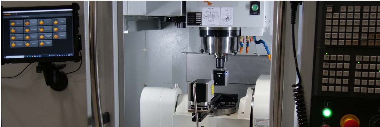
KES utilise le XM-60 sur les machines-outils à CN et les MMT pour effectuer des opérations de compensation volumétrique
