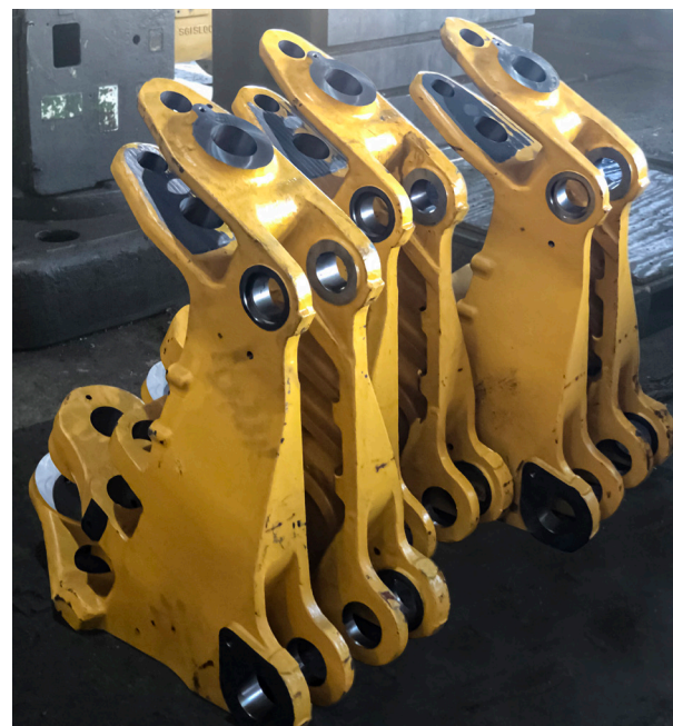
Composants de cadre oscillant utilisés dans l'industrie du terrassement
