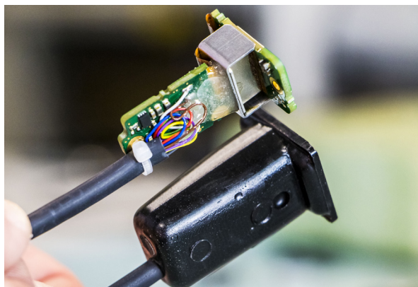
Le RLS LinACE™ reconditionné dans un boîtier étanche
