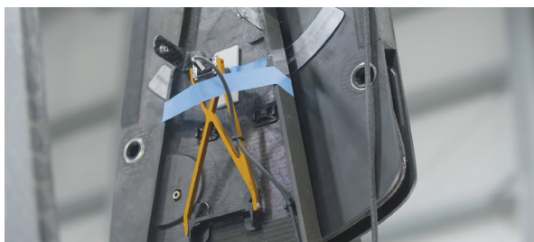
Les codeurs installés sur le "hammerhead" (disque de réglage du volet)
