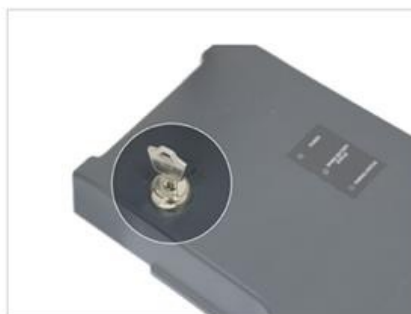
MCU W-2 en posición de bloqueo OFF, joystick desactivado
