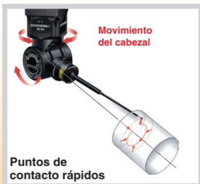
Para una serie de puntos alrededor de un orificio, los ejes del cabezal giran hasta la posición necesaria y después el palpador se desplaza un poco hacia fuera, tomando los puntos necesarios.
