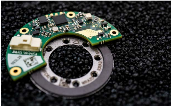
Encóder absoluto magnético con montaje sobre anillo AksIM™ (eje hueco) de RLS.
