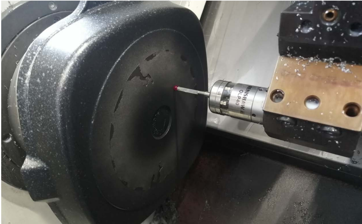
Sonda OLP40 de Renishaw detectando la posición de la pieza de fundición antes del mecanizado
