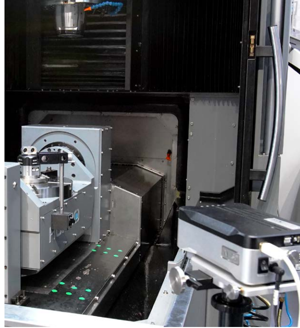
Hurco también utiliza el sistema de interferómetro láser XL-80 y el calibrador de ejes rotatorios XR20-W de Renishaw
