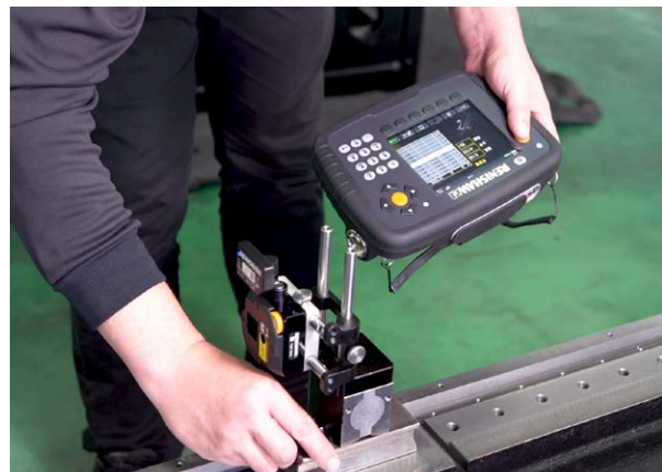
La unidad de pantalla del sistema XK10 obtiene, analiza y graba datos de medición
