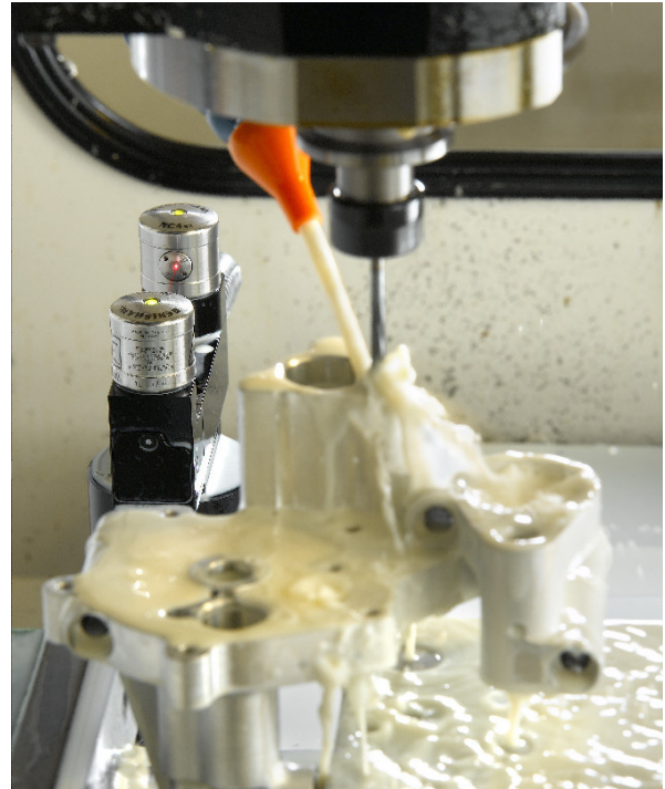
El sistema NC4 de Renishaw se utiliza para evitar los daños provocados por las herramientas rotas a unas piezas muy caras y así, eliminar piezas desechadas, repetición del mecanizado y pérdidas de tiempo.
