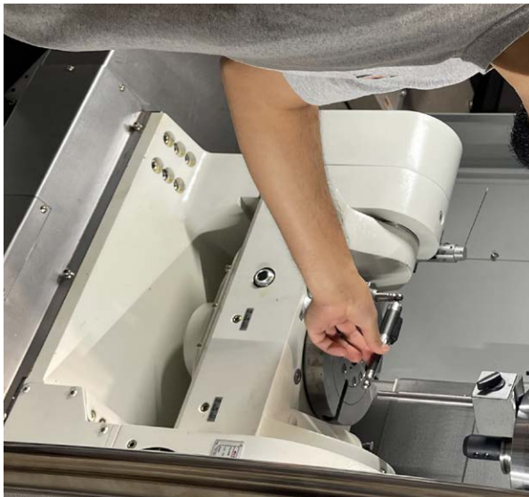
Sistema de ballbar QC20 de Renishaw
