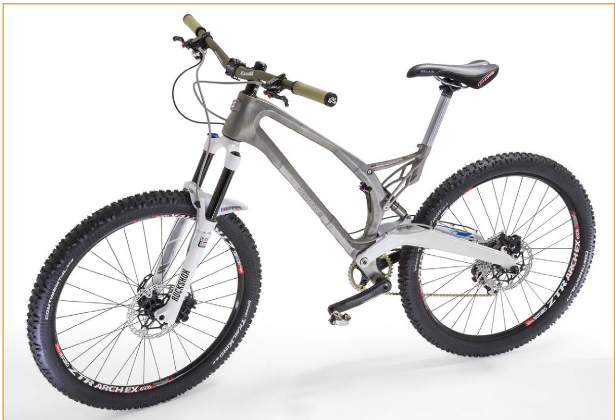
Bicicleta completa con cuadro de aleación de titanio y tubo vertical impresos en 3D
