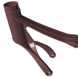
1. Modelo CAD de tubo vertical diseñado para fundición de aleación de aluminio
