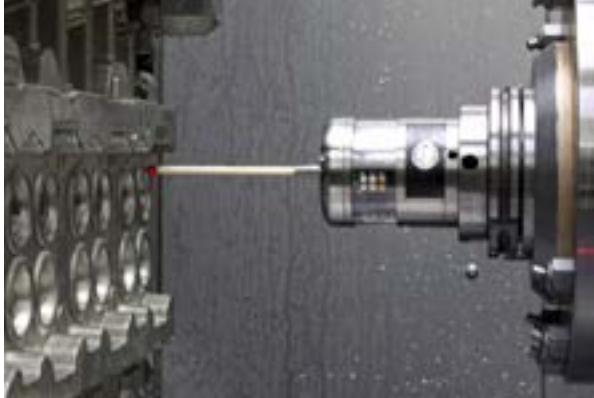
Sonda de transmisión óptica OMP60 de Renishaw midiendo los elementos principales del motor
