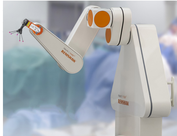
Robot estereotáctico neuromate con módulo de registro del paciente sin marco neurolocate
