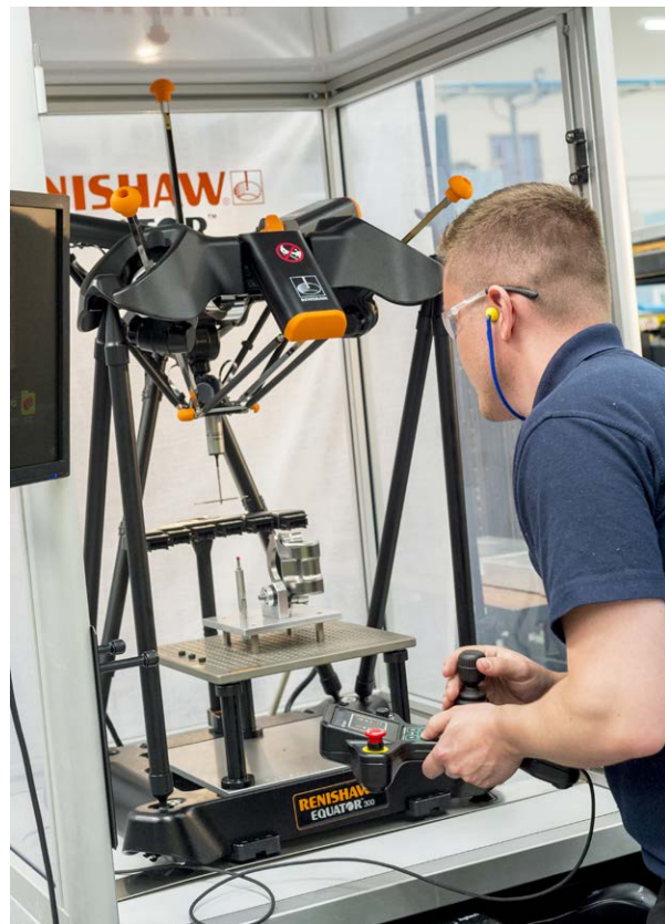
Sistema Equator inspeccionando una pieza aeroespacial programada
