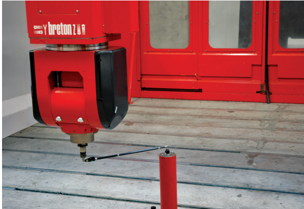
Breton emplea el ballbar QC20-W de Renishaw para verificar el rendimiento de posición de la máquina
