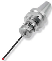
Palpeur pièce (Renishaw recommande vivement un palpeur à jauge de contrainte Rengage™)
