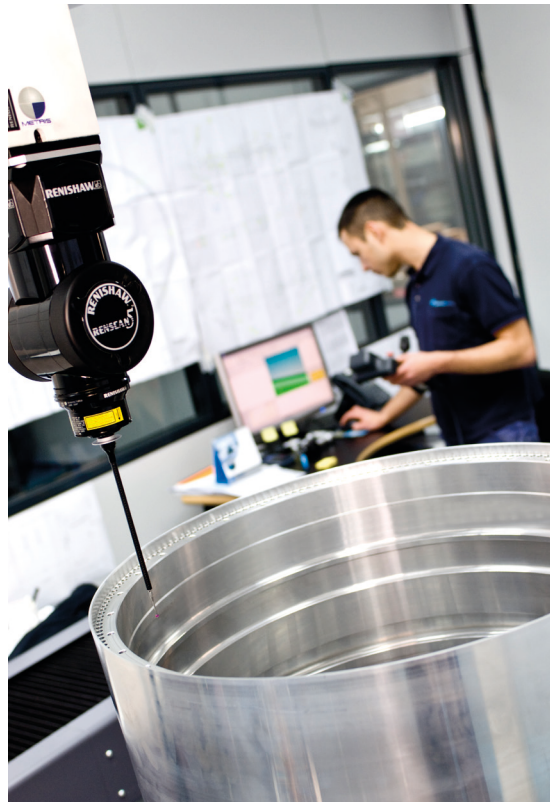
REVO scannant un grand alésage sur une pièce aéronautique.
