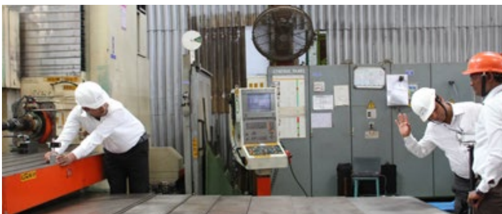
Osebe pri Godreju umerja CNC-stroj z laserjem XL-80
