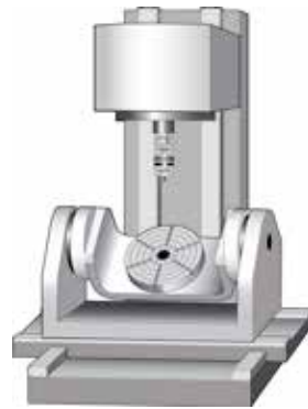
แมชชีนนิ่งเซ็นเตอร์ 5 แกนแนวตั้งและแนวนอนด้วยโต๊ะสไลด์ Trunnion
