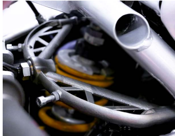
Composant monobloc en titane imprimé en 3D sur la moto TransFIORmers
