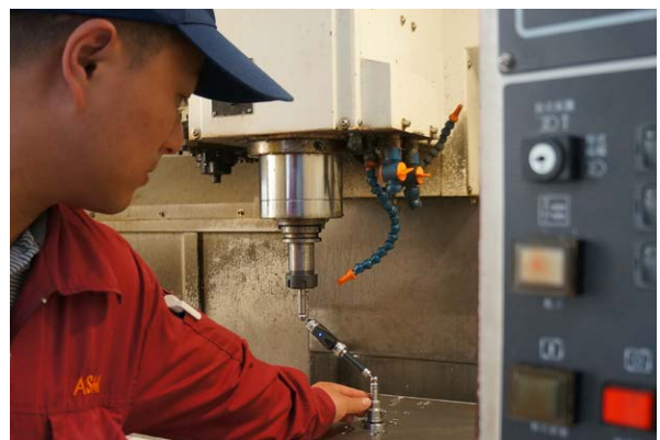
ASMPT의 생산 직원들은 정기적으로 공작 기계를 캘리브레이션합니다
