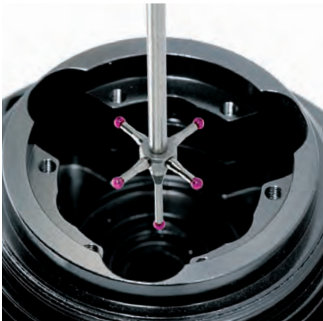
Medición de un contorno interior complejo
