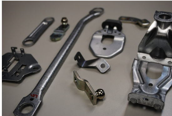
Eponsa fabrica piezas troqueladas del mecanismo de los limpiaparabrisas
