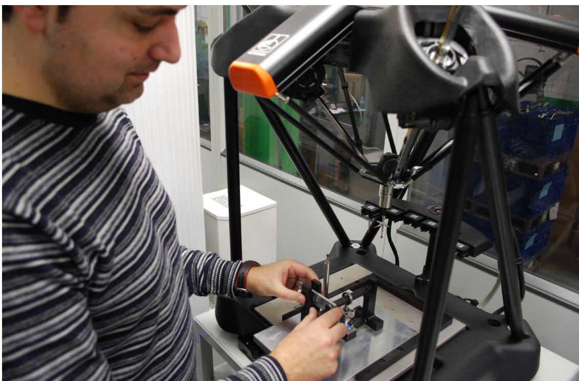
Un técnico de Eponsa carga una pieza del mecanismo de un limpiaparabrisas en Equator, preparado para la verificación
