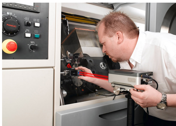
Calibrado de una máquina con un interferómetro láser
