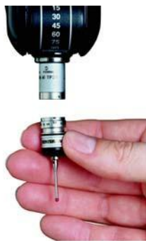
测针规格和配置可能影响测量结果的精度。
