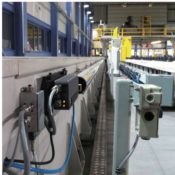
HS10激光尺的激光束在通有过滤空气的导管中工作
