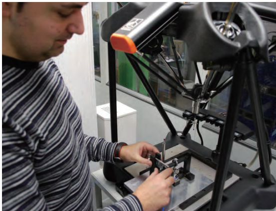
Eponsa工程师将雨刮器机构工件装载到Equator上，准备进行比对测量
