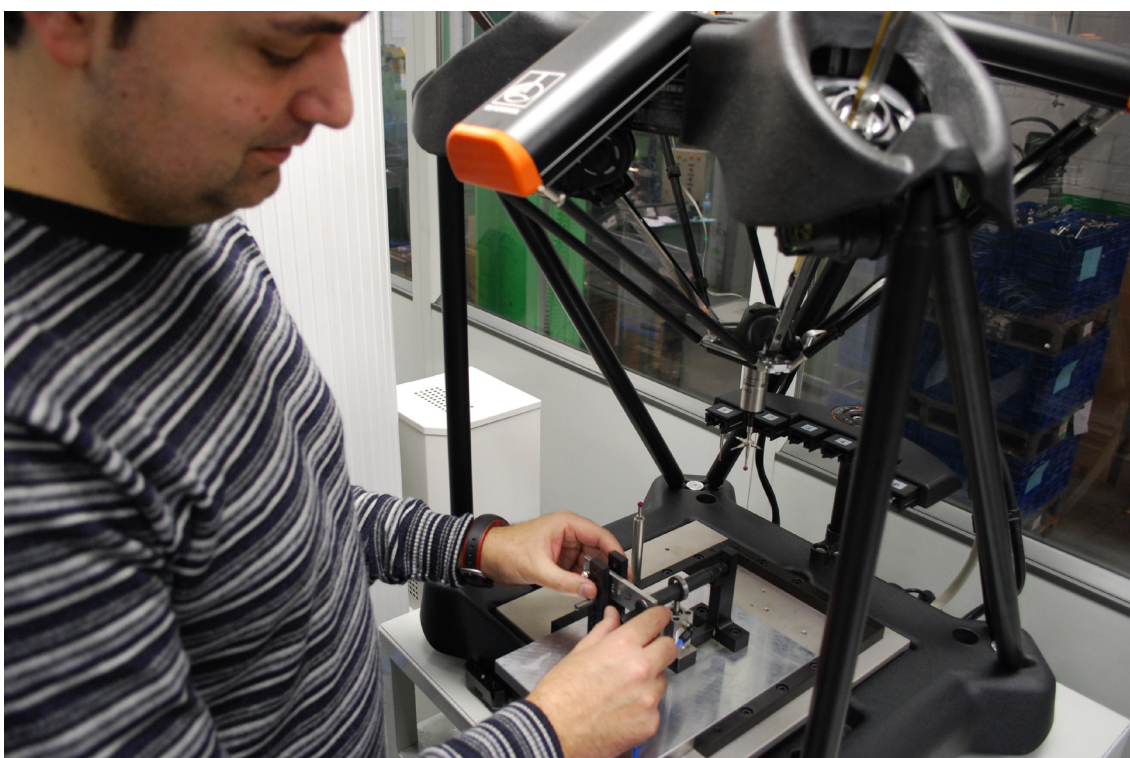
Un tecnico di Eponsa carica un componente per tergilistalli nel sistema Equator per eseguire la rilevazione del master
