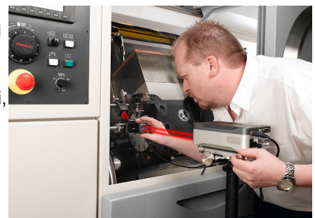
Calibrazione di una macchina con interferometro laser
