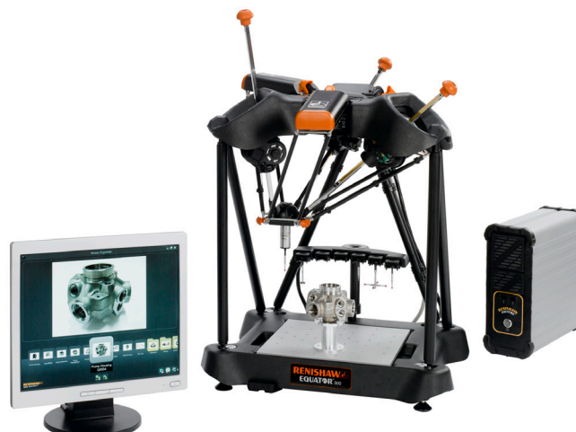
Ispezione rapida di pezzi di grandi volumi di produzione utilizzando il calibro versatile Equator™
