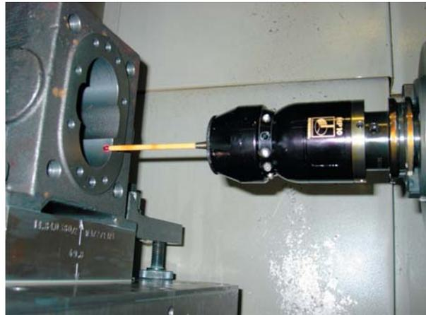
Bild 3. Wechselbare Tastereinsätze und eine optische Übertragung der Messdaten über den gesamten Umfang des Messtasters bei wahlweise 35 oder 70° Abstrahlwinkel ermöglichen den flexiblen Einsatz in sämtlichen Bearbeitungszentren
