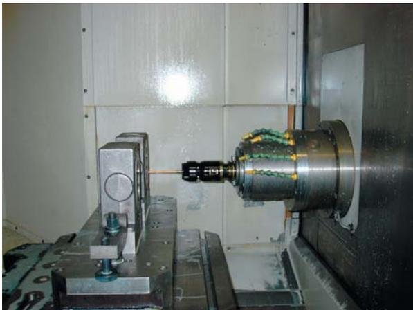
Bild 2. Automatisch in die Hauptspindel eingewechselte Messtaster erfassen im Arbeitsraum der Bearbeitungszentren rasch und genau die Position der Werkstücke für die Nullpunkt-Korrektur
