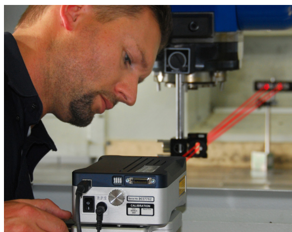
Diody LED umieszczone na górnej części XL-80 zapewniają prostotę konfiguracji. Możemy monitorować moc sygnału bez konieczności ciągłego przechodzenia do komputera PC" mówi Jürgen Emslander.
