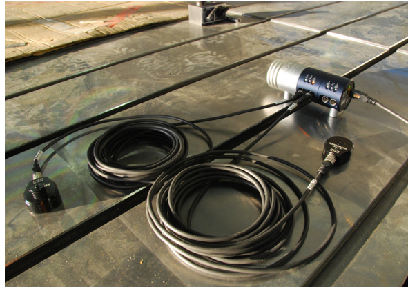
Czujniki połączone z modulem kompensacji XC-80 mierzą temperaturę i ciśnienie powietrza, umożliwiając przeprowadzanie testów w dowolnych warunkach
