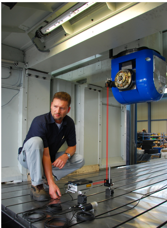
Con il laser XL-80 Jürgen Emslander può effettuare test di accuratezza in molte posizioni prima inaccessibili, anche all'interno delle macchine, come nel caso di questa Edel
