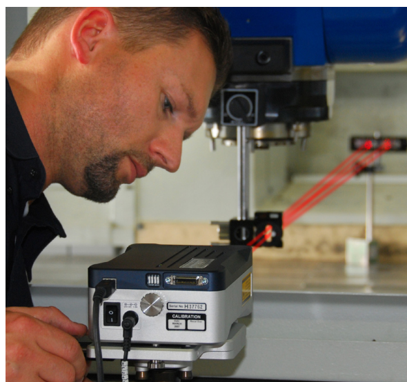
„LED diody nahoře na XL-80 velmi zjednodušují nastavení, můžeme sledovat sílu paprsku, aniž bychom běhali k PC a zpátky,“ říká Jürgen Emslander
