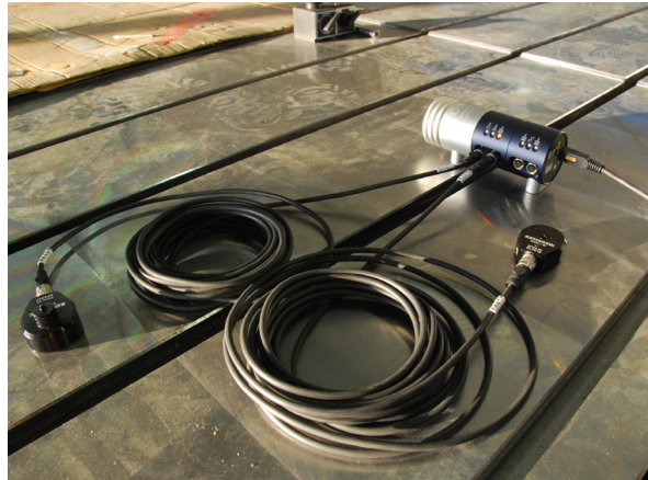
Snímače připojené ke kompenzační jednotce XC-80 měří teplotu a tlak vzduchu a umožňují tak zkoušet v libovolných podmínkách
