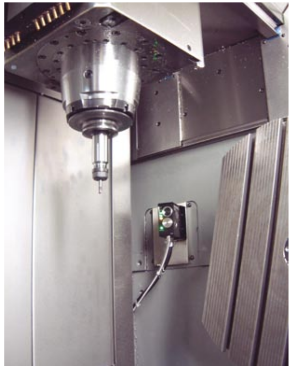
Ampel auf grün: Die Werkzeugbrucherkennung TRS2 sorgt für hohe Prozesssicherheit bei unbeaufsichtigtem Betrieb
