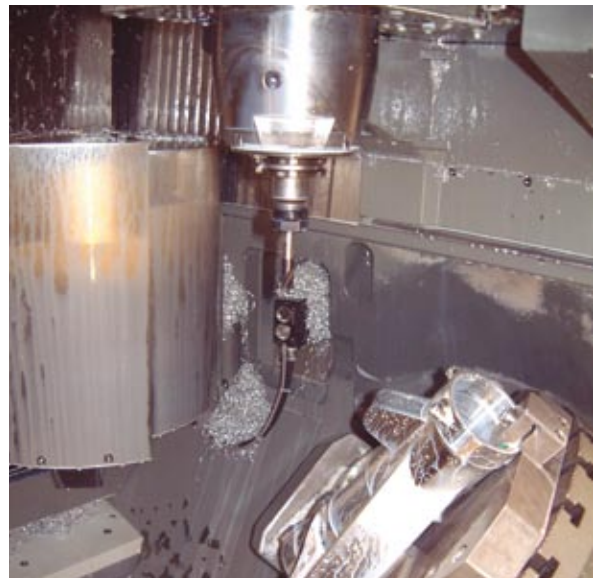
Zuverlässig in rauher Umgebung: Die Werkzeugbrucherkennung mit Laser arbeitet auch bei starkem Anfall von Spänen und Kühlmittel zuverlässig
