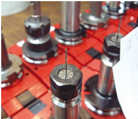
Bruchanfällig: Bei kleinen, schlanken Bohrern und Fräsern ist in einer Lohnfertigung das Standzeitende kaum vorherzusagen
